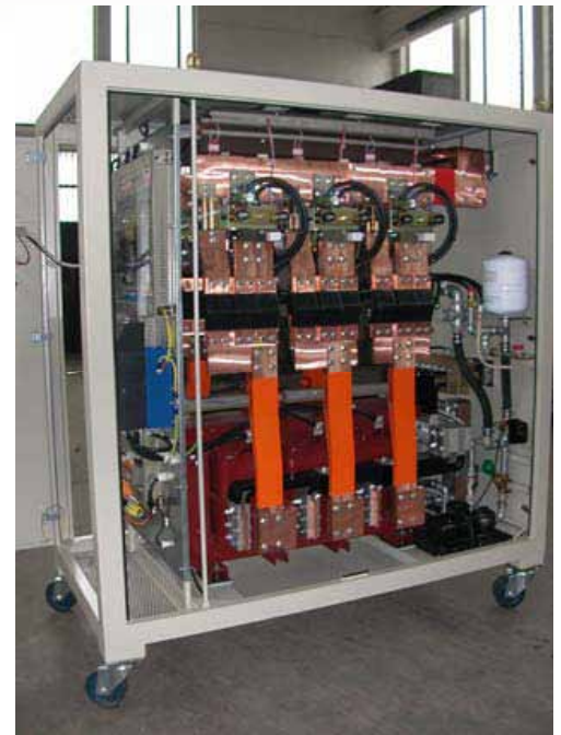
14V 17000A CON INVERSIONE – RAFFREDDAMENTO IN ACQUA 14V 17000A with reversing – water cooled
